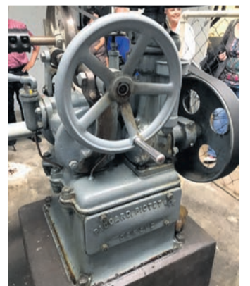
Turbine hydraulique (régulateur de régime) Piccard-Pictet et Cie construite à Genève.
